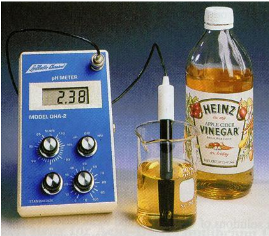
ΣΧΗΜΑ 3.5 Ο προσδιορισμός του pH με πεχάμετρο μπορεί να γίνει με μεγάλη ακρίβεια.
